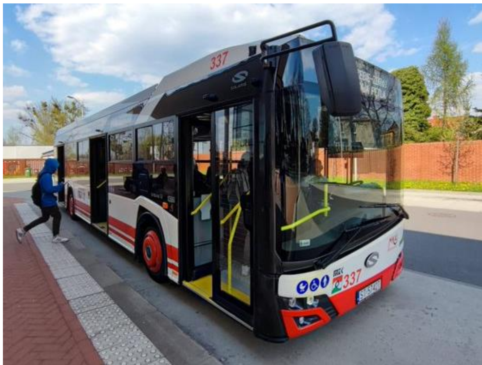
Rys. 9.1 W pełni niskopodłogowy autobus LF typu maxi na linii MZK Źródło: Zbiory własne
